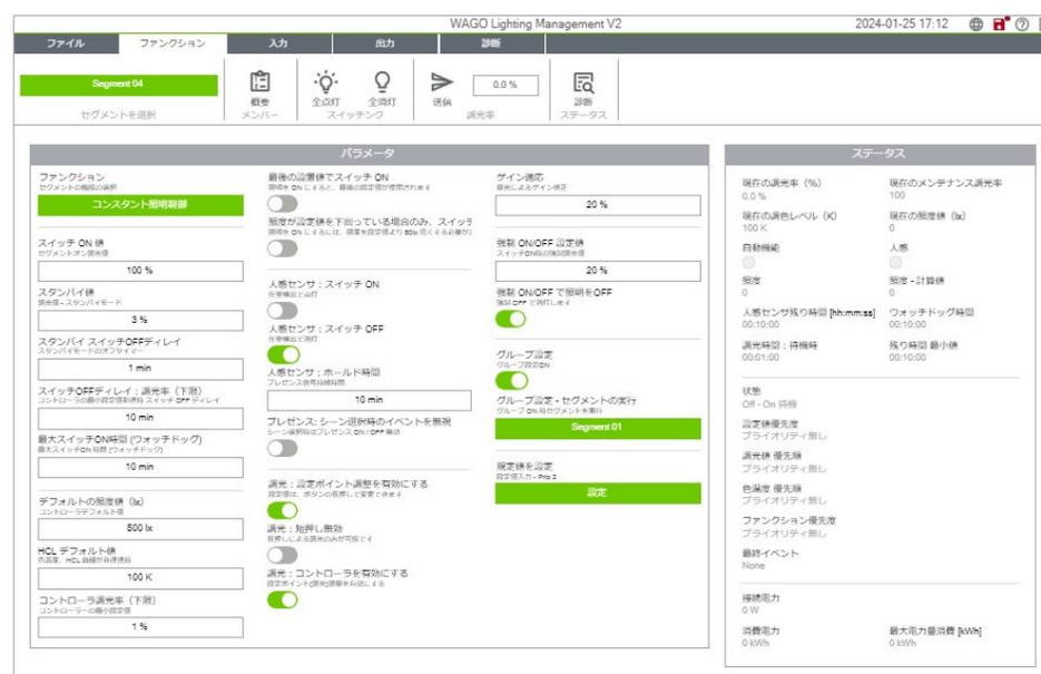
図 58: ファンクションー照明制御ーコンスタント照明制御
