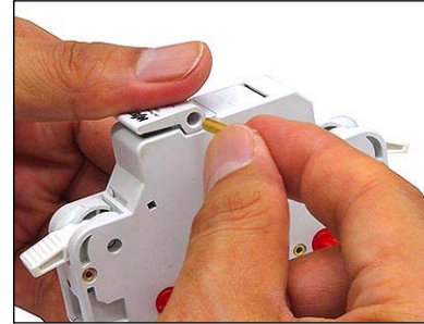
②金属製ピンをヒューズ収納 部に1個取り付けます。
