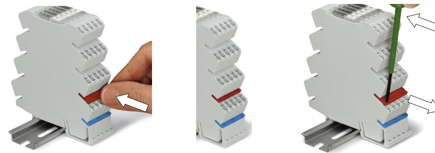
完全に固定するまで差込型ジャンパを押し込む 固定した状態 差込型ジャンパの取り外し方
