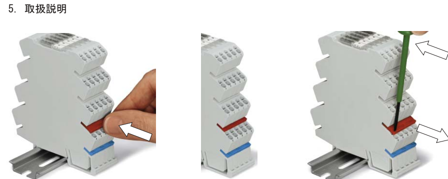
完全に固定するまで差込型ジャンパを押し込む | 固定した状態 | 差込型ジャンパの取り外し方
