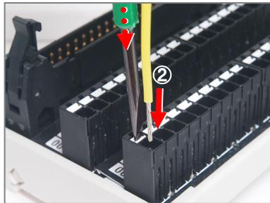
② ボタンを押しながら、正しくむき出した電線を電線挿入口に突き当たるまで差し込みます。
