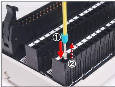
◎単線は正しい長さでむき出し、フェルールの場合は長さが合ったものを圧着します。
