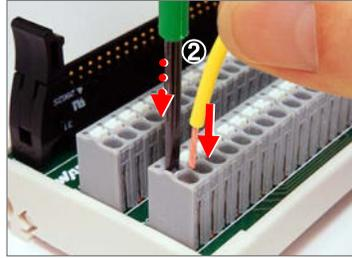
② 操作ボタンを押しながら、正しくむき出した電線を電線挿入口に突き当たるまで差し込みます。
