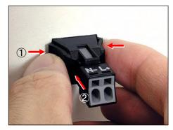
パネル裏面から、①コネクタ両側 のロックを押さえながら②パネル 穴に押し込みます。
