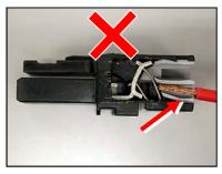
あやまってドライバスロット に電線を差し込んだ場合。 導電部に接触しないので、通電 不良、発熱の恐れがあります。
