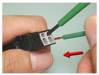
②正しくむき出した電線を電 線挿入口から突き当たるまで 差し込みます。
