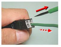
③ドライバを抜けば結線できま す。確認のため、電線を軽く引っ 張ってください。
