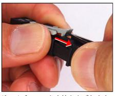
ドライバでロックを持ち上げたまま、 ソケットを引き抜きます。
