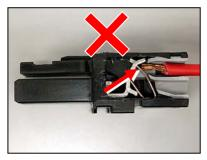
むき長さが短く、電線が正しくクランプされなかった場合。通電不良 や発熱の恐れがあります。
