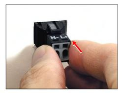
ロックが外れたら、パネル表面へ押し 出して取り外します。
