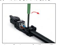
ケーブルクランプの溝に刃幅 2.5mmのドライバ(210-719)を 差し込み、ツメのロックを外 します。
