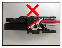
むき長さが短く、電線の被覆を かんでしまった場合。通電不 良、発熱の恐れがあります。
