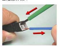
より線の結線作業①と同様の 方法でスプリングを開放すれ ば、電線を取り外せます。
