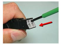
①ドライバを操作用スロット (角穴)に斜めに差し込みます。 正しく差し込めばドライバは 保持されます。
