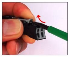
ドライバをロックのくぼみ部分に 突き当てて持ち上げます。
