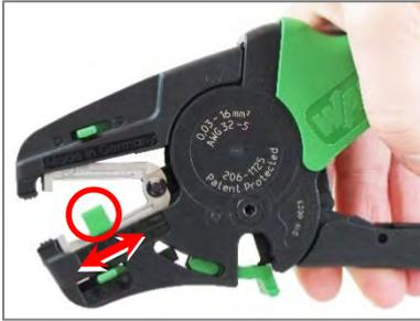
ストリッピングストップをつまみ、電線被覆むき長さにスライドさせて調節します。
