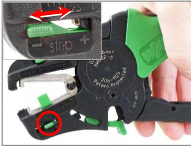
部分ストリップ調節部を+または-方向にスライドして、被覆除去位置を調節できます
