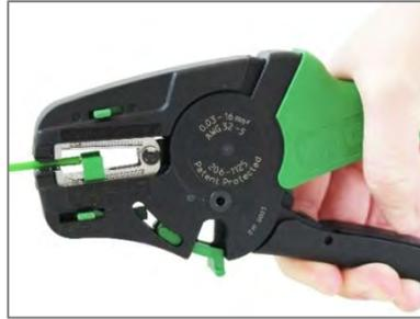
電線をストリッピングストップに突き当たるまで差し込みます
