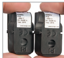
左右のラッチで 2 個を組み付け
