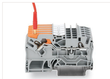
テスト： 検電穴に Ø 2 mm のテストプラグが使用可能です (最大試験電圧 42 V)
