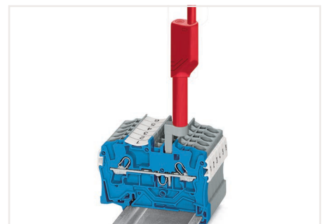
テストプラグアダプタを取り付けることで Ø 4 mm テストプラグまたはバナプラグを使用した導通試験が可能です
