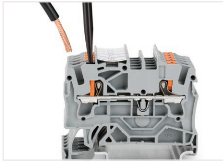
可とうより線 / より線： ドライバでボタンを押し、電線を挿入します 電線を押さえたままドライバを離せば結線されます ※プッシュイン接続できない細い単線およびフェール 圧着線もボタン操作で結線可能です
