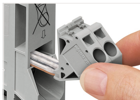
給電口(ジャンバスロット)にボルテージタップを差し込みます 電線接続はボルテージタップの差し込み後に行います
