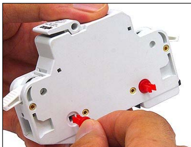
①樹脂製のピンを端子台の 2箇所に取り付けます。
