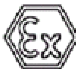
図 14 : ATEX, IEC-Ex 準拠 I/O モジュールの側面マーキング例
