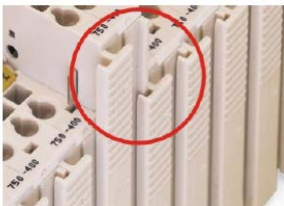
図 7 : I/O モジュールの挿入
